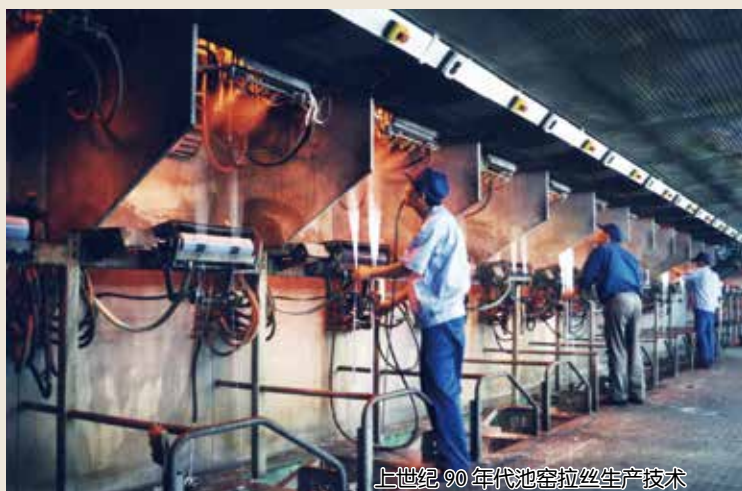
中国巨石第一座年产8000吨中碱玻纤池窑拉丝生产线
