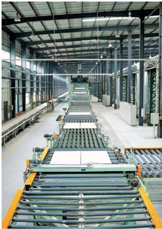
年产3000万平方米纸面石膏板生产线
