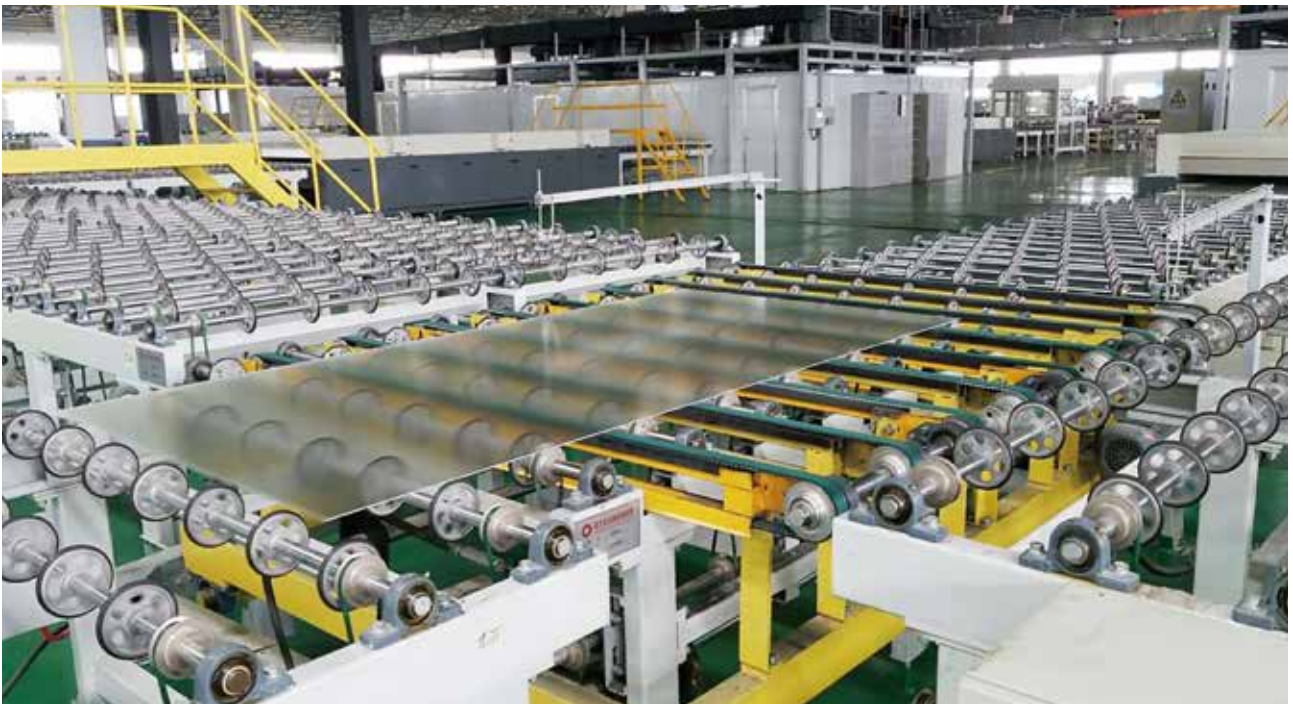
碲化镉发电玻璃生产线
